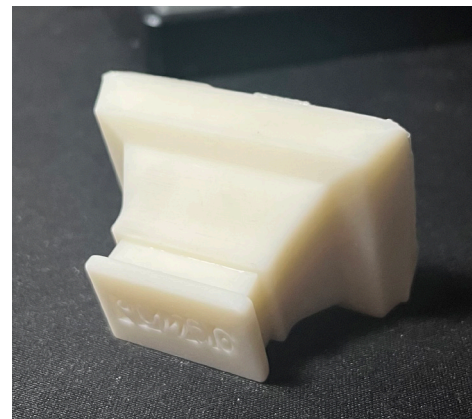
Abb.52 Harzstempel Version 1 Rückseite
