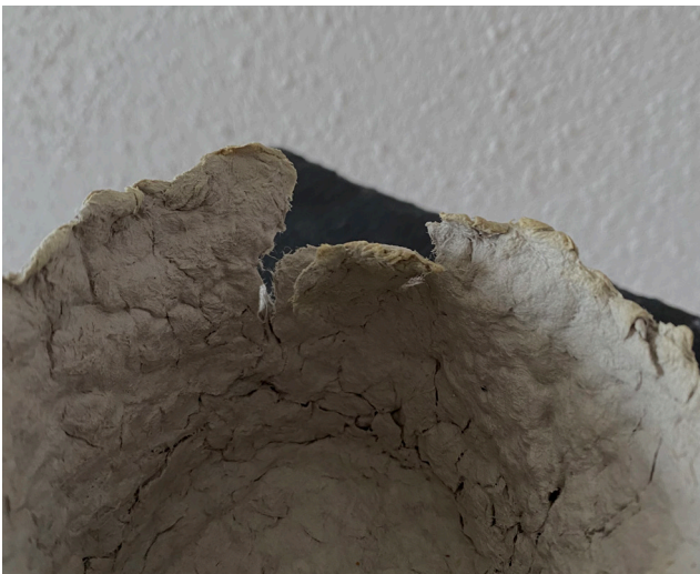
Abb.145 Die entstandenen Risse
