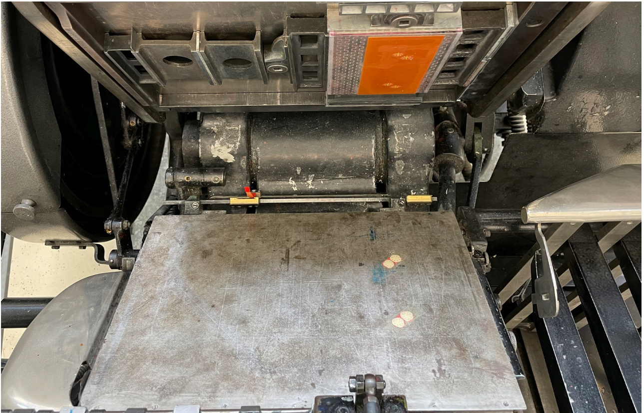
Abb.67 Beide Prägeformen eingespannt
