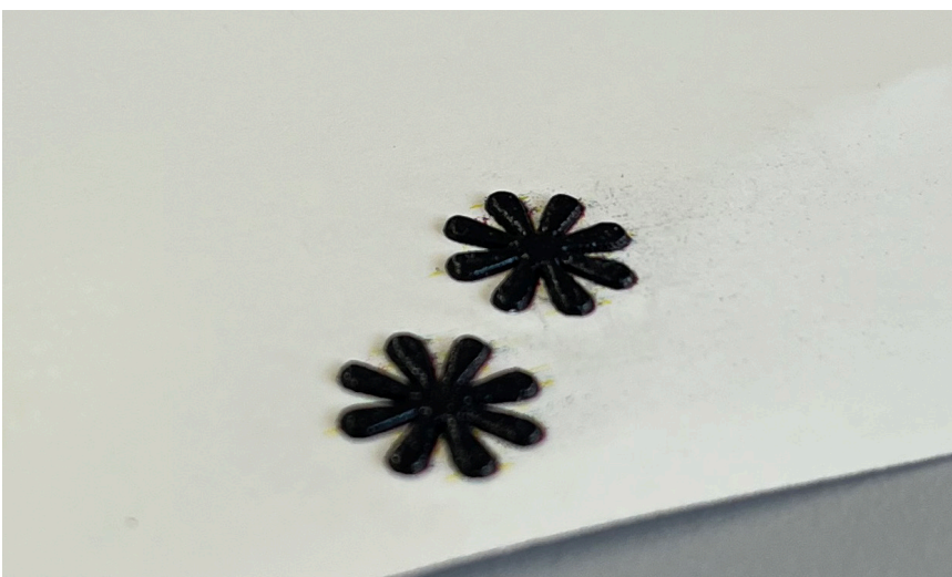
Abb.64 20 Farbschichten im Large Format Druck
